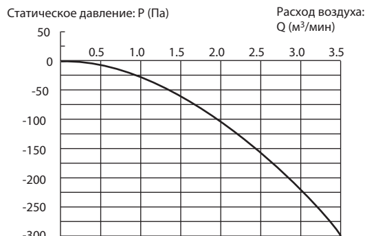
Расход приточного воздуха (подача воздуха в блок)
