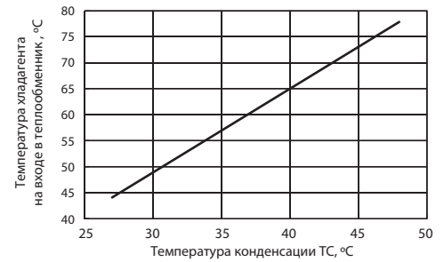
Рис. 2. Температура хладагента на входе в теплообменник
